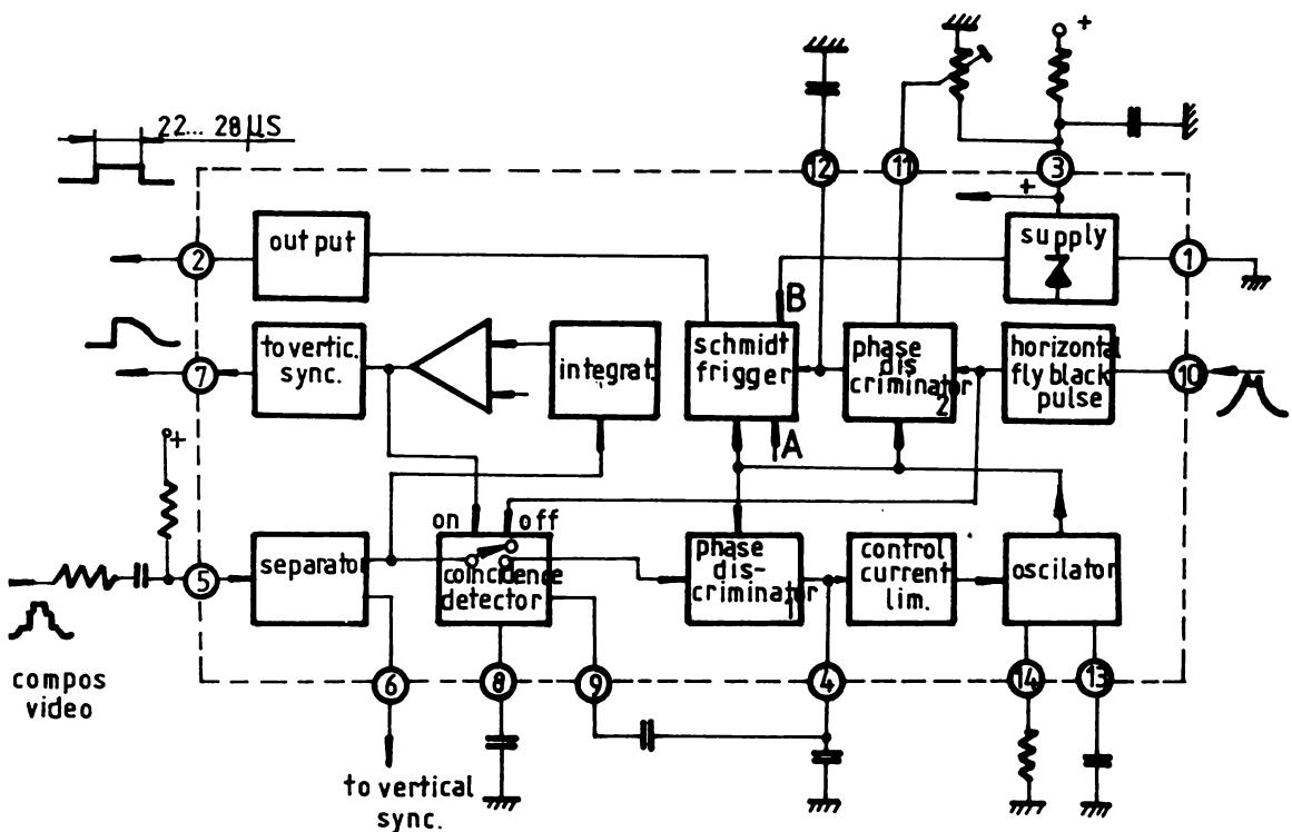
Cind lipsesc impulsurile de sincronizare a liniilor, oscillatorul intern are o frecventa libera de oscilatie a carei valoare este determinata de doua componente externe  $R_7=10.5$  K $\Omega$  1% si  $C_6=10$  nF 2%, la  $15625$  Hz  $\pm 10\%$ .
